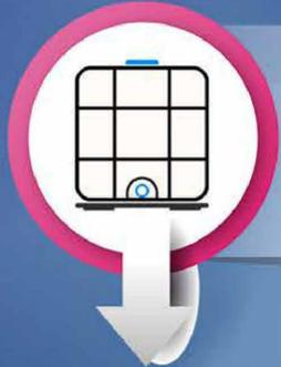
Almacene y despache agua, pesticidas u otros líquidos y polvos. Tanque de polietileno de alta densidad resistente a químicos está rodeado por una jaula de acero galvanizado. Instalados sobre una tarima con marco de acero para transportar fácilmente. Entrada para montacargas por 4 lados.
